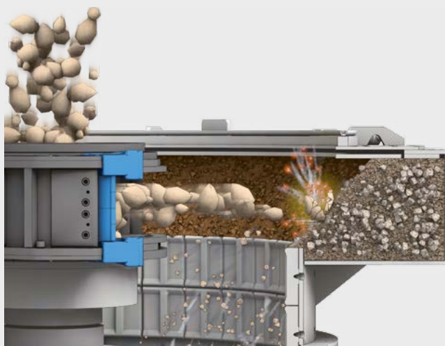
Funktionsprinzip mit Materialbett
