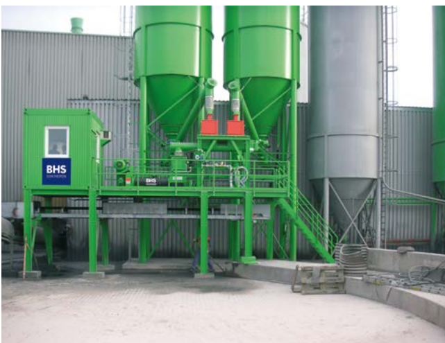
Kontinuierliche Mischanlage zum Befeuchten von Abfallstoffen
