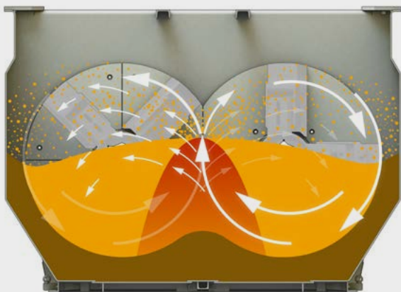
Doppelwellen-Durchlaufmischer (LFK) für grobes Material
