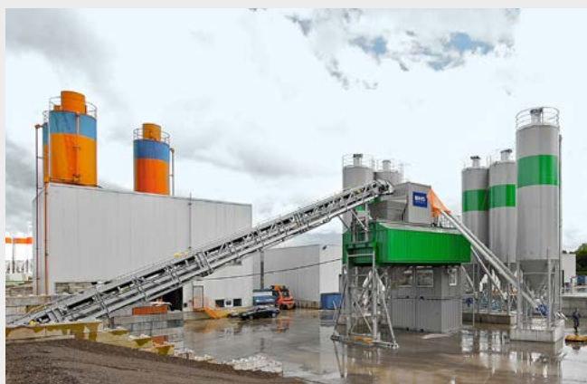
MONOMIX 3,00 zur Herstellung von Transportbeton und Fertigteilbeton
