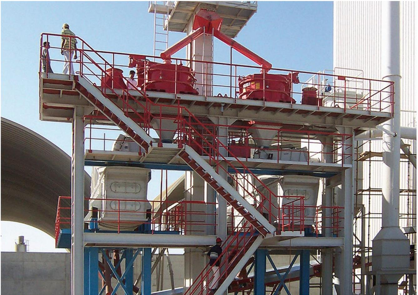
Einsatz zweier Rotorprallmühlen vom Typ RPM 1513 in einer Trockenmörtelanlage in den Vereinigten Arabischen Emiraten (VAE)
