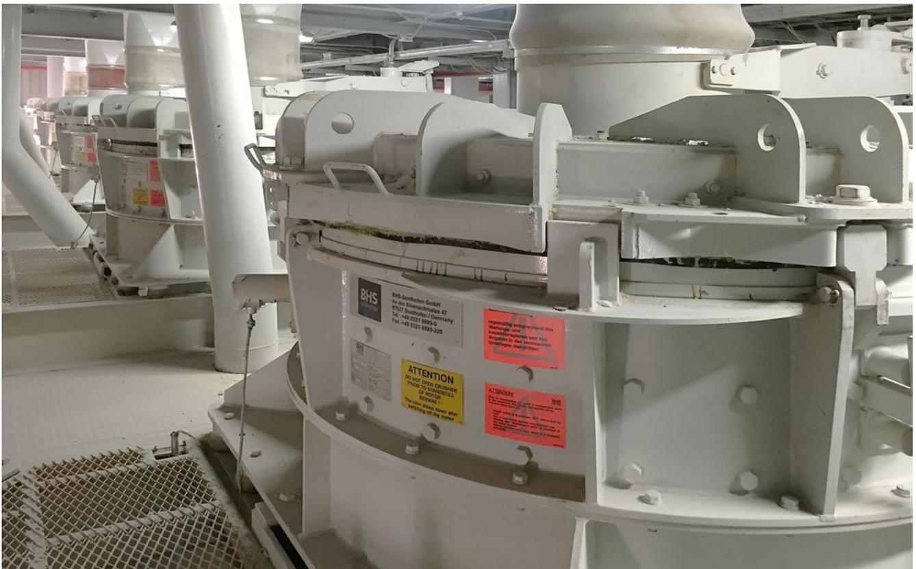
In einem Trockenmörtelwerk in Thailand arbeiten fünf BHS Rotorprallmühlen vom Typ RPM 1513
