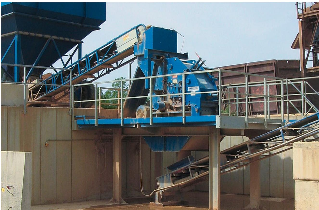
Utilisation d'un Concasseur à Percussion BHS de type PB 0806 pour le concassage de granulats résiduels de gravier entre 32 et 250 mm pour la fabrication de gravillons commercialisables.
