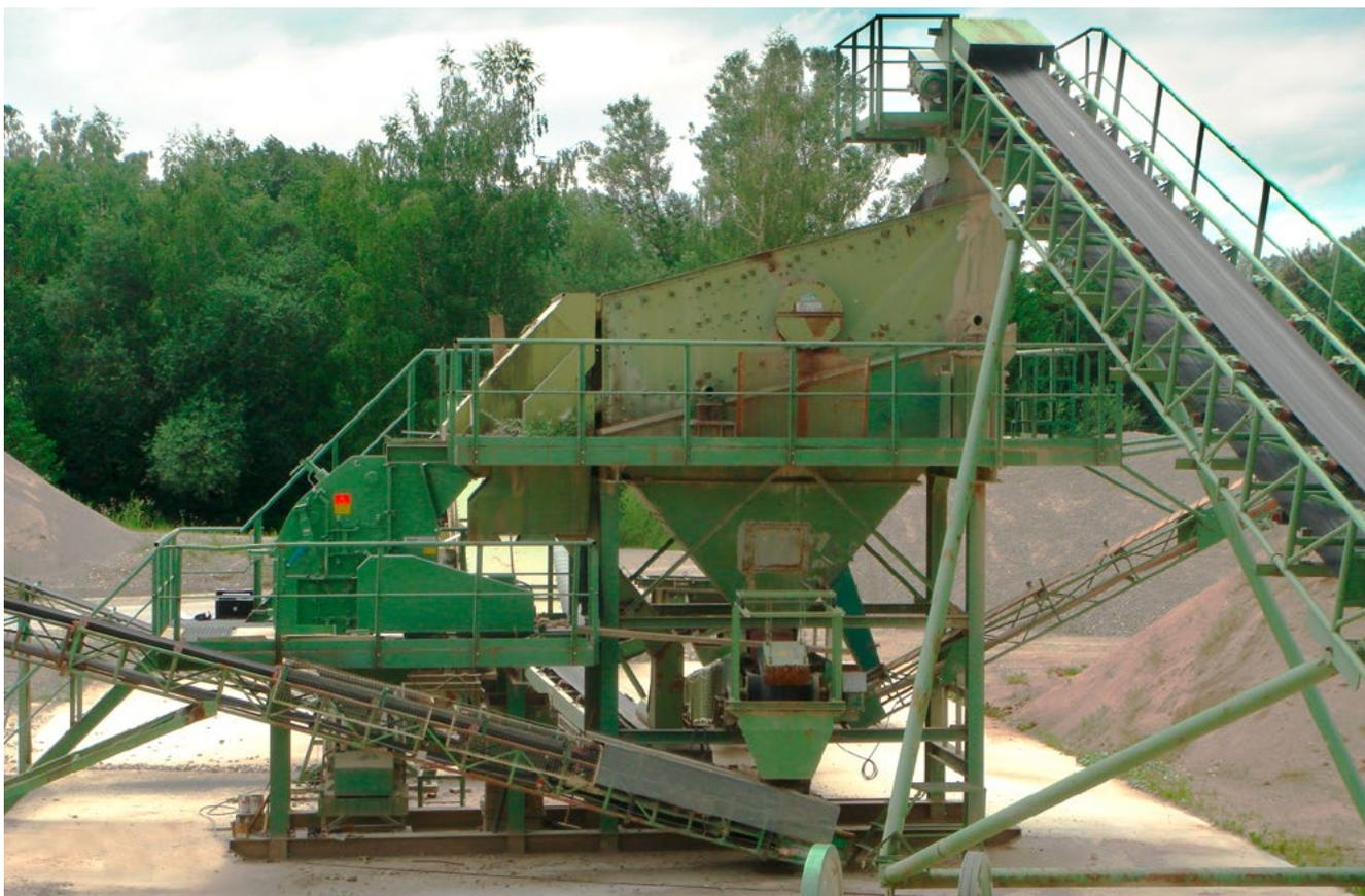
Broyeur à Percussion BHS de type PM 0806 pour le concassage de recyclage de béton et de granulats résiduels de gravier. Dans le cadre de la modernisation de l'installation, le Broyeur à Percussion remplace un Concasseur à mâchoires.
