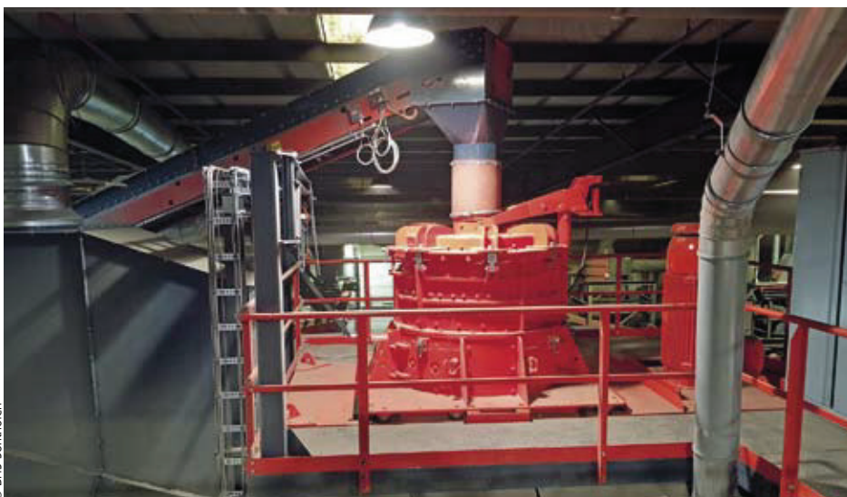
Die Rotorprallmühle (Typ RPMX) von BHS kommt mit stark abrasiven Materialien gut zurecht The rotor impact mill (type RPMX) from BHS can handle heavily abrasive materials
