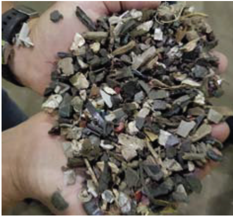
Im Aufgabematerial befinden sich wertvolle Metalle – aber auch Glas und Mineralik / The input material contains valuable metals but also glass and minerals
