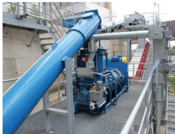
Kontinuierliche Mischanlage zum Befeuchten von Flugasche
